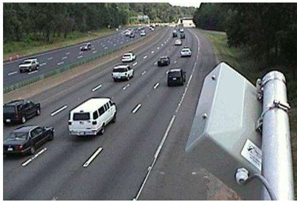
FIGURE 2.7 – Capteur acoustique SAS (extrait de www.smarteksys.com).
