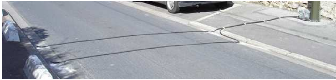
FIGURE 2.8 – Tuyau pneumatique (extrait de http://www.iprocia.fr ).
