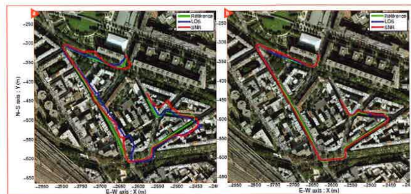
Figure 6 : Comparaison des méthodes de localisation GNSS. En bleu, méthode de tri des satellites LOS/nLOS par calcul géométrique ; en rouge, discrimination par utilisation du rapport signal/bruit (SNR) ; en vert, trajectoire de référence. À gauche : sans recalage sur la voirie ; à droite, avec recalage
