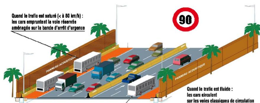
Figure 7: Élargissement de l'A57 (Toulon) à 2x3 voies. Variante "élargissement avec circulation facilitée des cars" proposée en concertation (2009).
