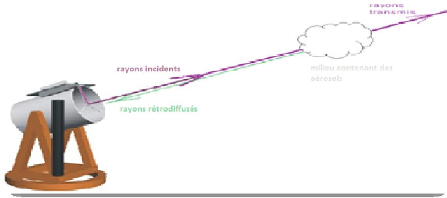
Image I-1: Fonctionnement du LIDAR à rétrodiffusion. Image récupérée du site web de l'IGN [2]
