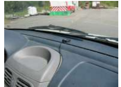
Figure 4 : L'antenne patch derrière le pare-brise
