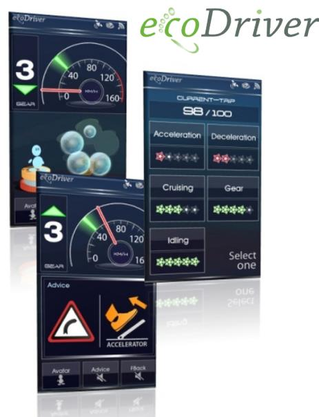
Interface graphique de l'application d'aide à l'écoconduite pour smartphones, mise au point par l'IFSTTAR-LIVIC dans le cadre du projet européen ecoDriver
