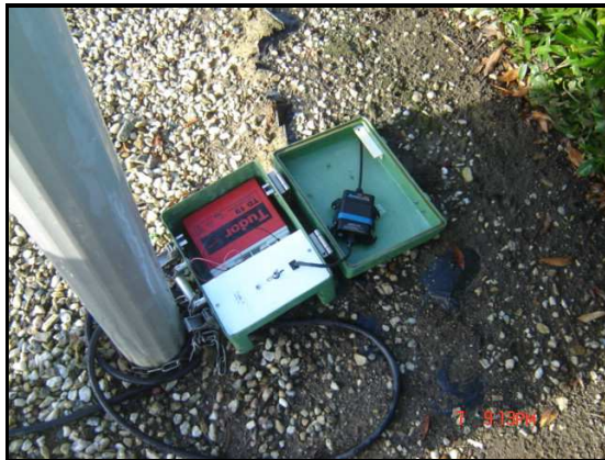
Figure 5 : boîtier de détection des véhicules sur la voie secondaire
