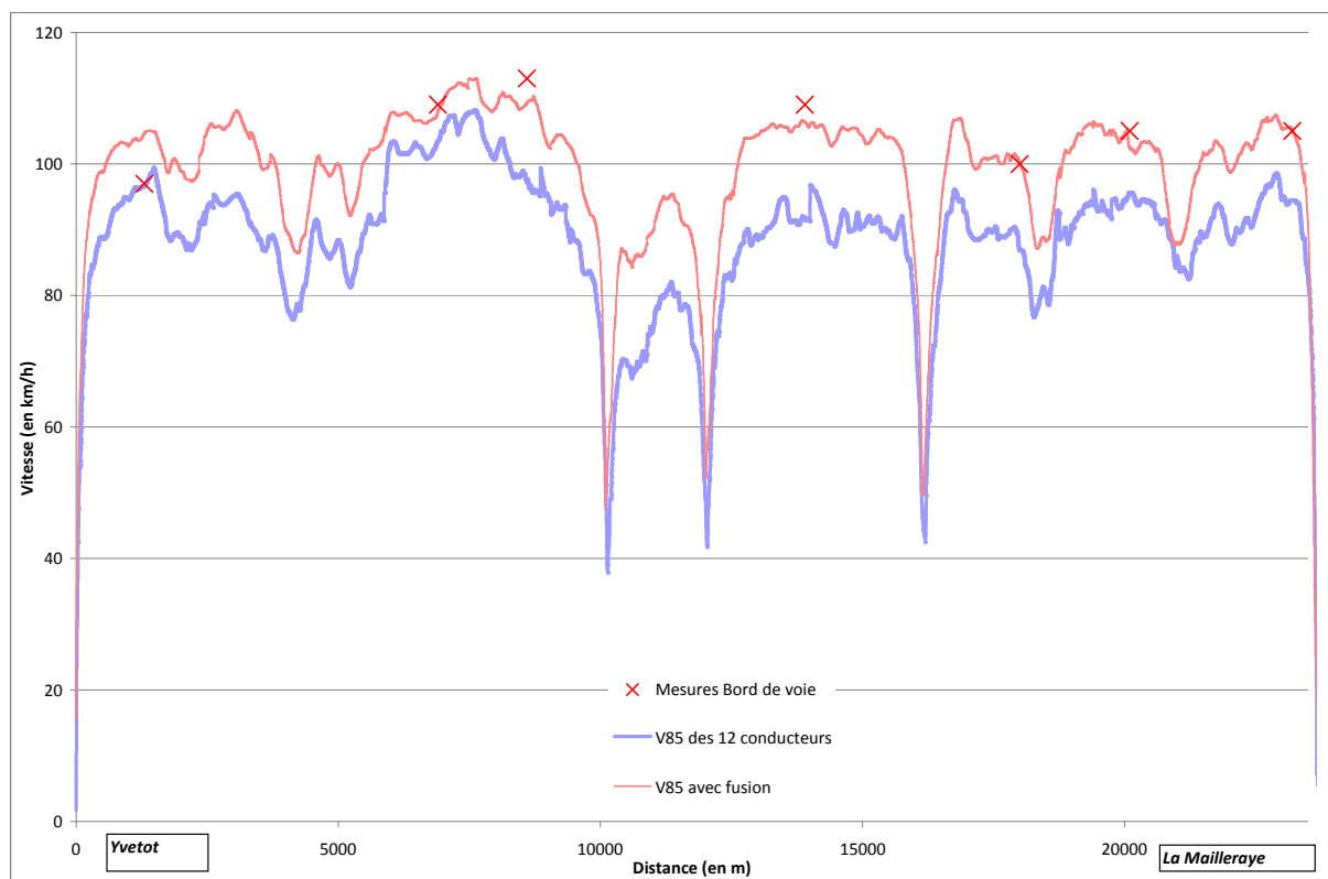
Graphique 3 : Comparaison entre profil V_{85} avec et sans fusion de données
