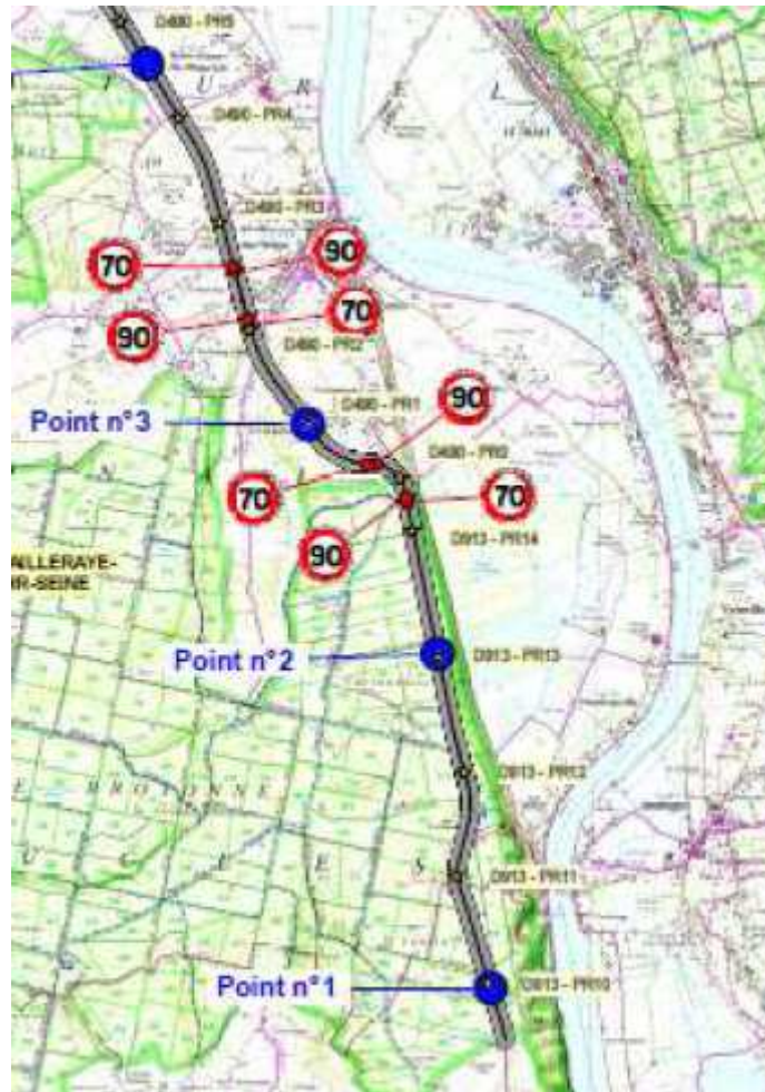
Figure 19 : Schéma d'implantation des points de mesure de vitesse
