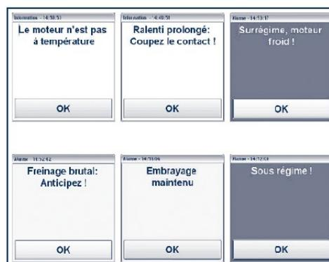
**Figure 15 : Messages affichés en temps réel au conducteur**
